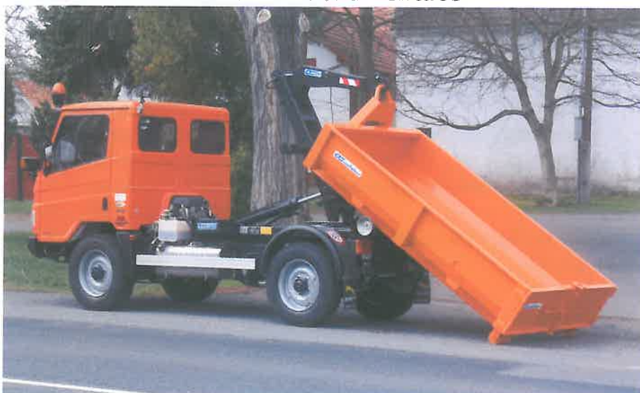
Nosič komunálních nástaveb BONETTI 4x4 typ: F100X/35E5 verze: SCHASIS K DOSTAVBĚ
