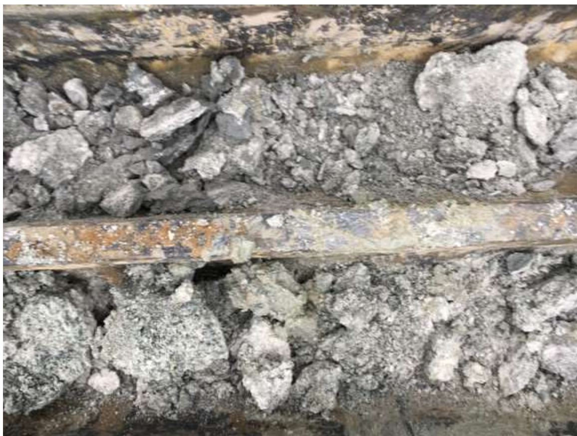
Foto č.2: Detail zvětralých kaolinizovaných horizontů
