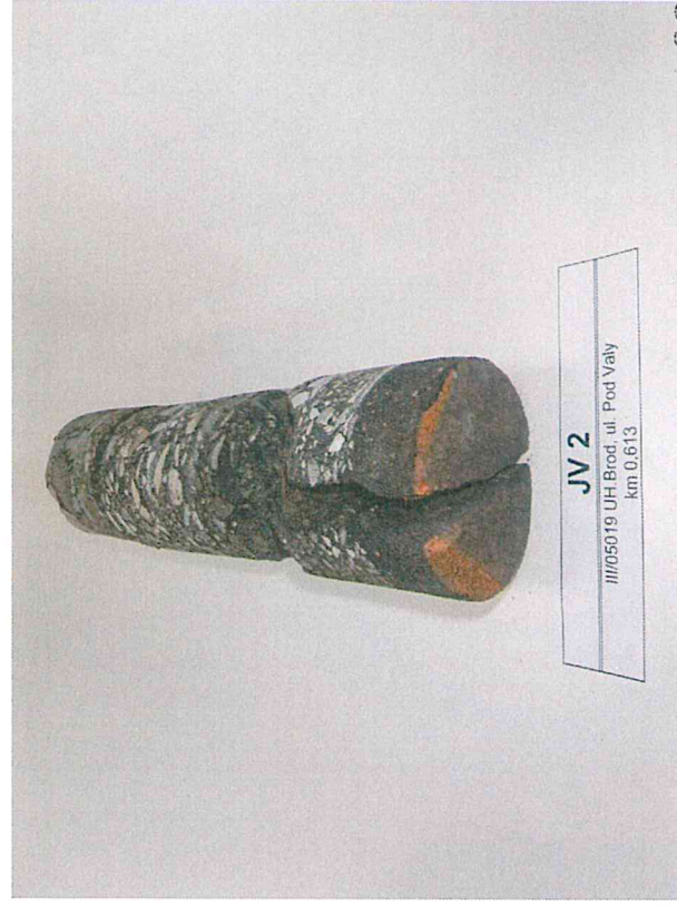
Foto č. 3 – Detail vývrtnu JV 2 (Příčná trhlina)
