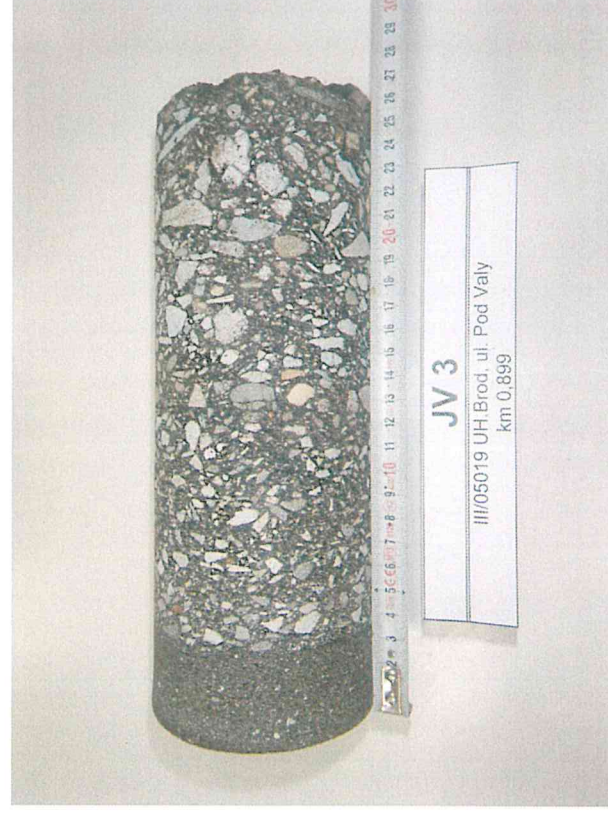
Foto č. 4 – Detail vývrtnu JV 3 (V koleji, 25 mm)
