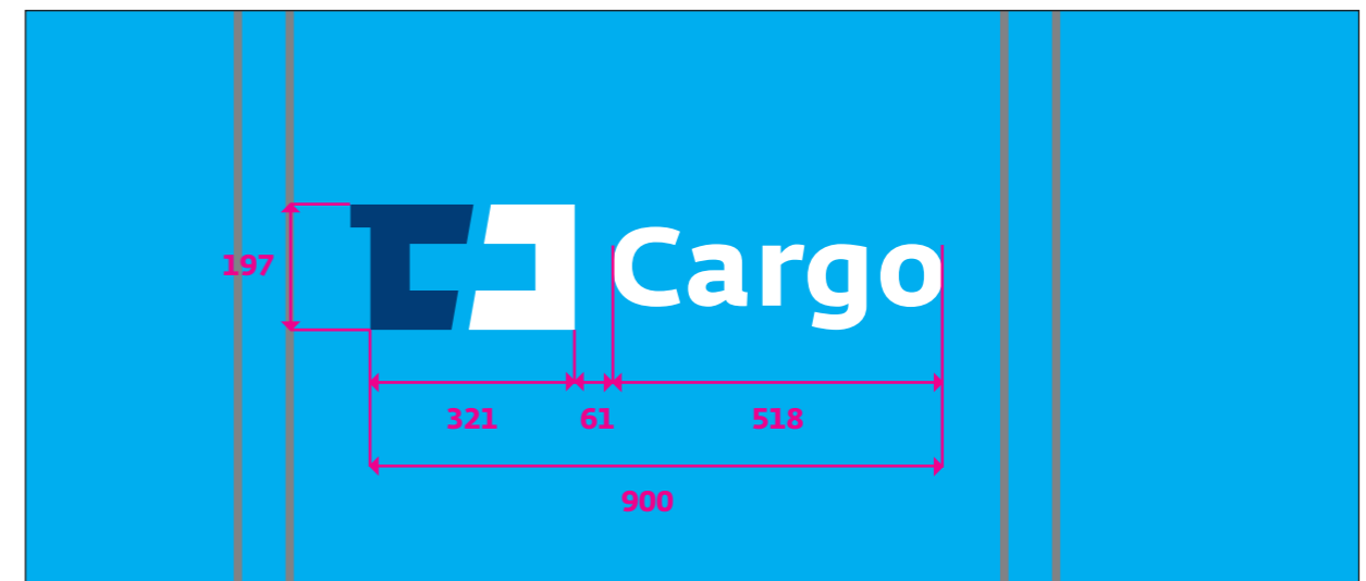
Eas 51, 52, 53, 54 – detail umístění značky – barevné negativní provedení značky 1 (viz 2/3) na podkladu ČD Cargo světle modrá
