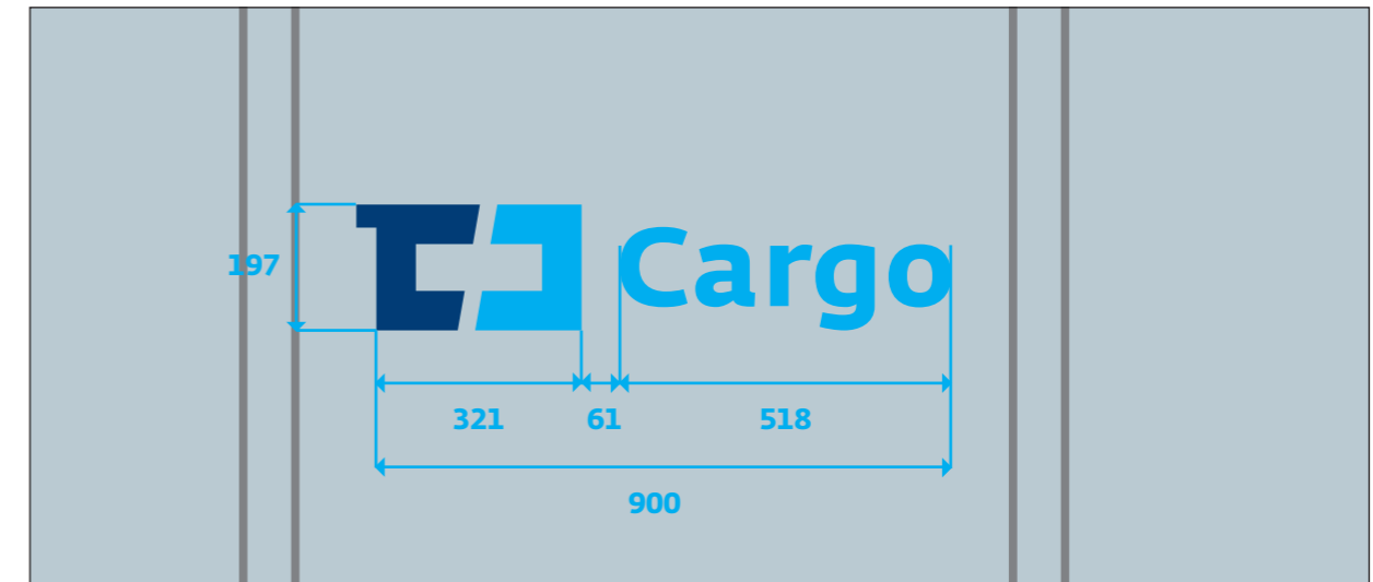
Eas 11 – detail umístění značky – barevné pozitivní provedení značky (viz 2/3) na podkladu stříbrná
