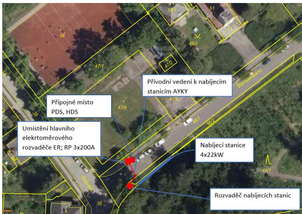
Obrázek č.8 - Ilustrativní zakres připojení dobíjecích stanic k distribuční síti
