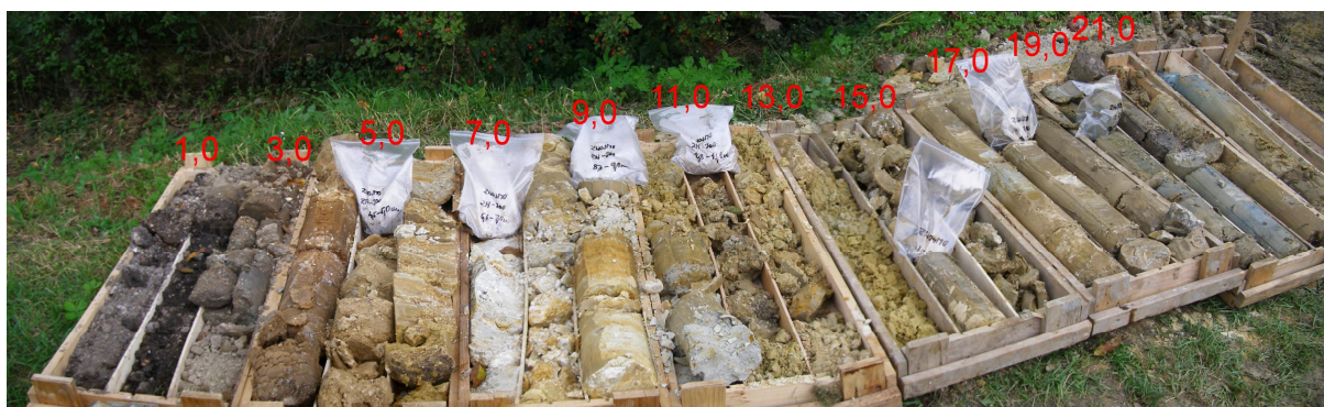
Foto 2 Petrografický profil vrtem ZN-300, metráž 0,0 – 22,0 m
