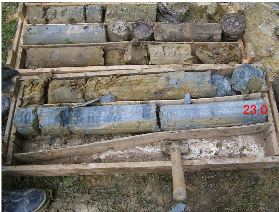
Foto 3 Petrografický profil vrtem ZN-300, metráž 19,0 - 23,0 m
