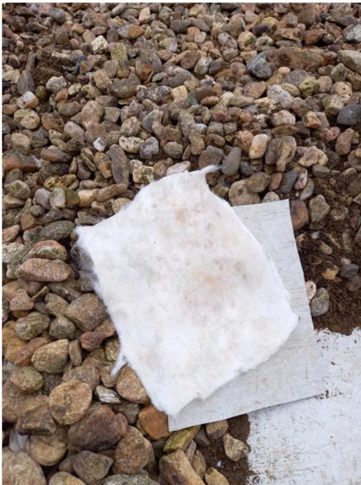
Fotografie 4 – Vyříznutá hydroizolace a separace – mokré.
