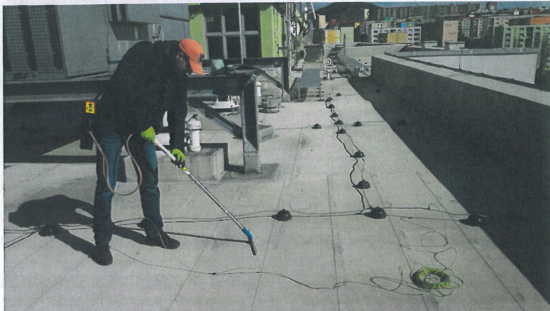
Foto 11a a 11b – pohled na příklady míst nalezených netěsností
