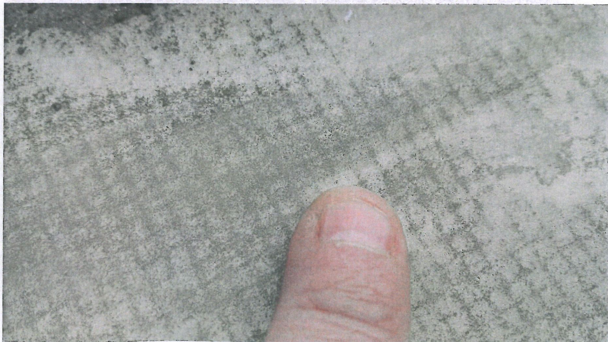
Foto 18 – pohled na povrch materiálu kde je vidět obecně narušená struktura
