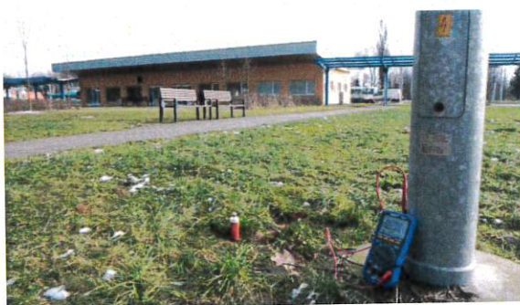
Obr. 20 Měření potenciálu sloup VO
