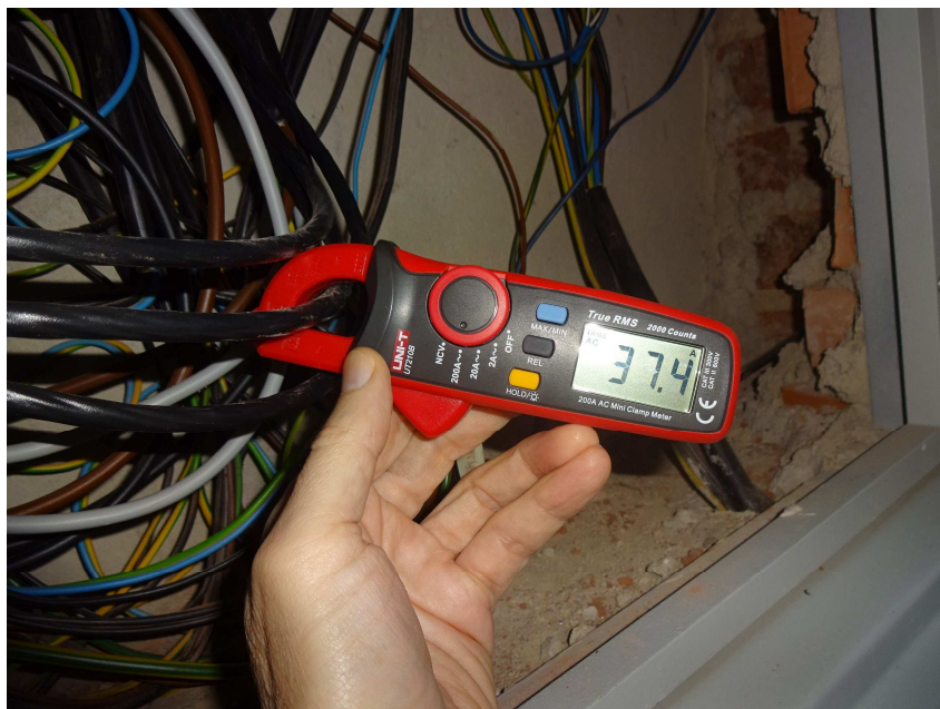
kontrolní měření soudobého proudového zatížení napájecího vedení pro výdejnu stravy
