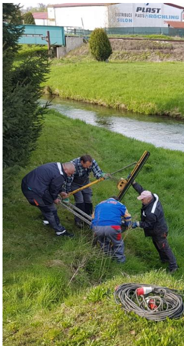
Fotodokumentace výnosu – vrtného jádra ze sondy V2. Umísťování a provoz vrtné soupravy pro hloubení vrtu V2
