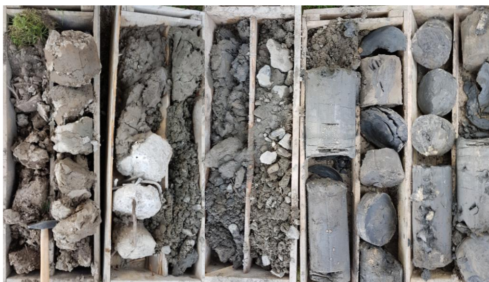
Fotodokumentace výnosu – vrtného jádra ze sondy VI
