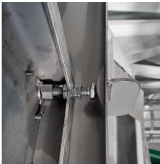
Obr. 2 – seřizovací šroub přitlaku desky
