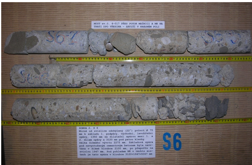
Obr. G43-106 SONDA č. S6. Mírně od svislice odchýlený ( 22^\circ ) průvrt \varnothing 75 mm k základu 1. podpěry, východní, levobřežní opěry, 1350 mm za dilatační spárou mezi 1. a 2. dílem opěry a 3120 mm pod patou klenby. Délka šikmého vývrtu 2275 mm. Základová spára pod nevyztuženým cementovým betonem byla navrtána v šikmé hloubce 2100 mm, po přepočtu na svislou 1947 mm. Pod pohledem NK v těchto místech je tato spára v hloubce 3120 + 1947 = 5067 mm.
