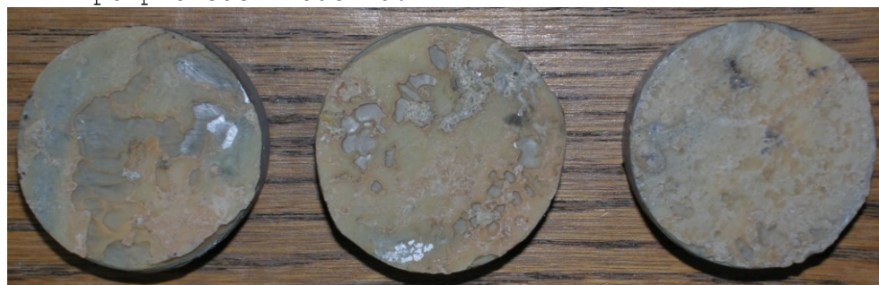
Obr.G43-112 Zkušební terče číslo 108, 161, 194 (zkušební místo 2) po provedení odtrhu.
