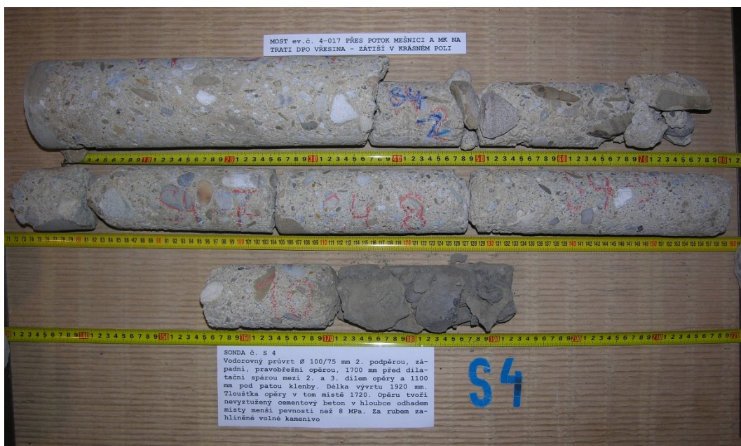
Obr. G43-104 SONDA č. S4. Vodorovný průvrt \varnothing 100/75 mm 2. podpěrou, západní, pravobřežní opěrou, 1700 mm před dilatační spárou mezi 2. a 3. dílem opěry a 1100 mm pod patou klenby. Délka vývrtu 1920 mm. Tloušťka opěry v tom místě 1720 mm. Opěru tvoří nevyztužený cementový beton, v hloubce odhadem místy menší pevnosti než 8 MPa. Za rubem zahliněné volné kamenivo.
