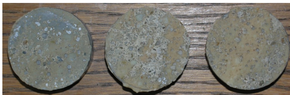
Obr.G44-113 Zkušební terče číslo 160, 99, 122 (zkušební místo 3) po provedení odtrhu.
