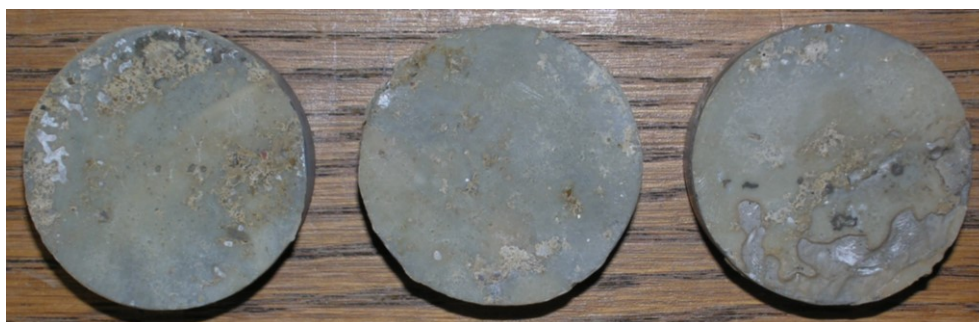
Obr.G44-111 Zkušební terče číslo 37, 137, 164 (zkušební místo 1) po provedení odtrhu.
