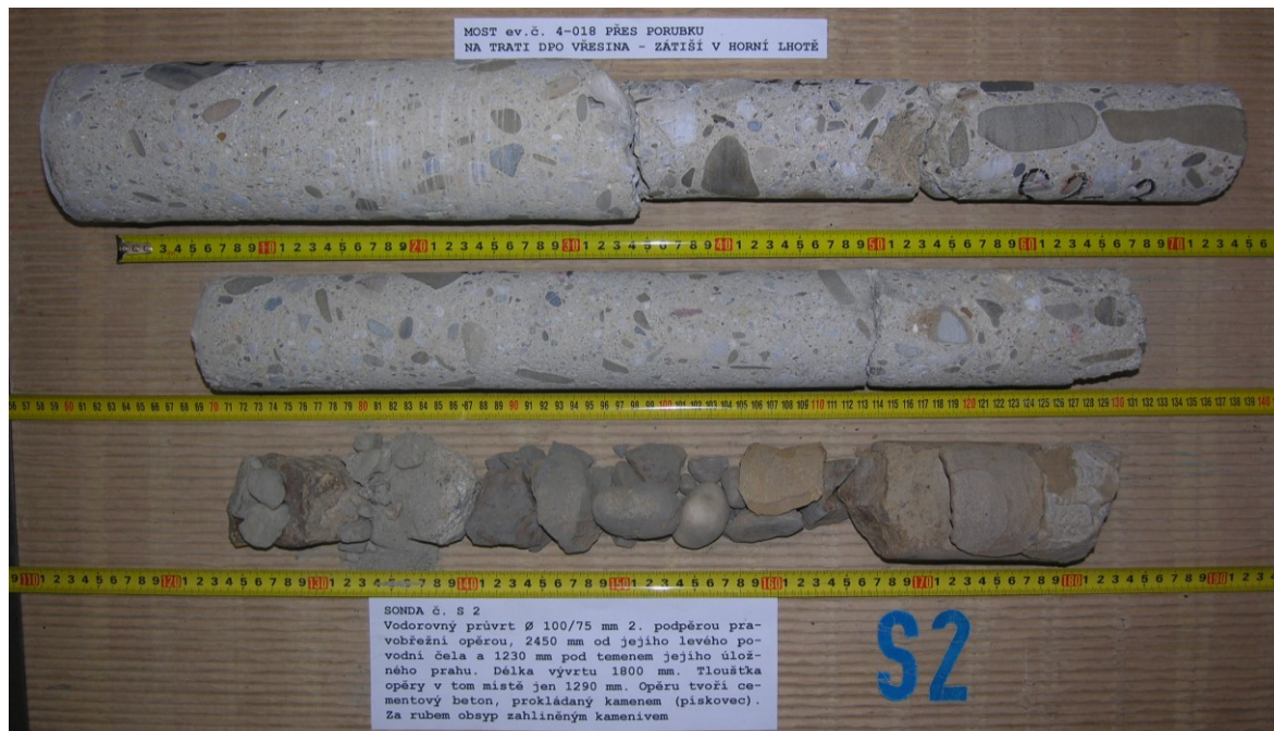
Obr. G44-202 Sonda č. S2. Vodorovný průvrt \varnothing 100/75 mm 2. podpěrou, pravobřežní opěrou, 2450 mm od jejího levého (povodního) čela a 1230 mm pod temenem jejího úložného prahu. Délka vývrtu 1800 mm. Tloušťka opěry v tom místě je 1290 mm. Opěru tvoří cementový beton prokládaný kamenem (pískovcem). Za rubem obsyp zahliněným kamenivem.
