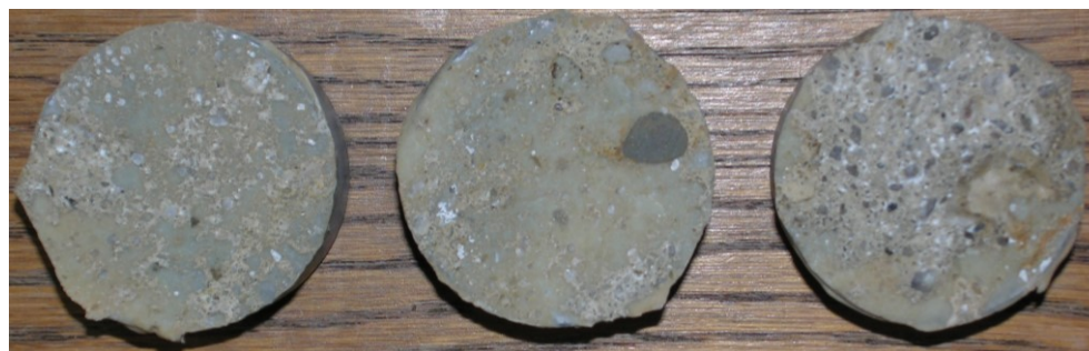
Obr.G44-112 Zkušební terče číslo 1, 27, 135 (zkušební místo 2) po provedení odtrhu.
