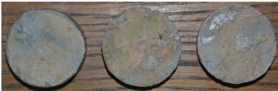
Obr.G44-114 Zkušební terče číslo 53, 184, 193 (zkušební místo 4) po provedení odtrhu.
