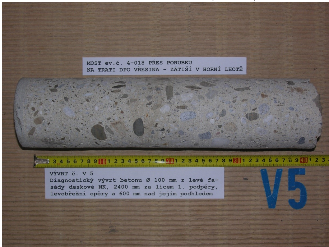
Obr. G44-105 VÝVRT č. V5. Diagnostický vývrt betonu Ø 100 mm z levé fasády deskové NK, 2400 mm za lícem 1. podpěry, levobřežní opěry a 600 mm nad jejím pohledem. U zkušebního místa NDT (Schmidt) č.26.
