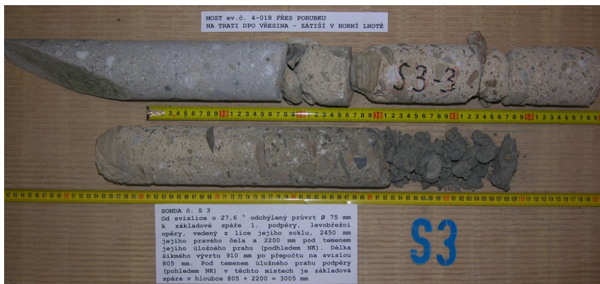
Obr.G44-203 Sonda č. S3. Od svislice odchýlený (27,6°) průvrt Ø 75 mm k základové spáře 1. podpěry, levobřežní opěry, vedený z líce jejího soklu, 2450 mm od jejího pravého čela a 2200 mm pod temenem jejího úložného prahu (podhledem NK). Délka šikmého vývrtu 910 mm po přepočtu na svislou 805 mm. Pod temenem úložného prahu podpěry (pohledem NK) v těchto místech je základová spára v hloubce 805+2200=3005 mm.
