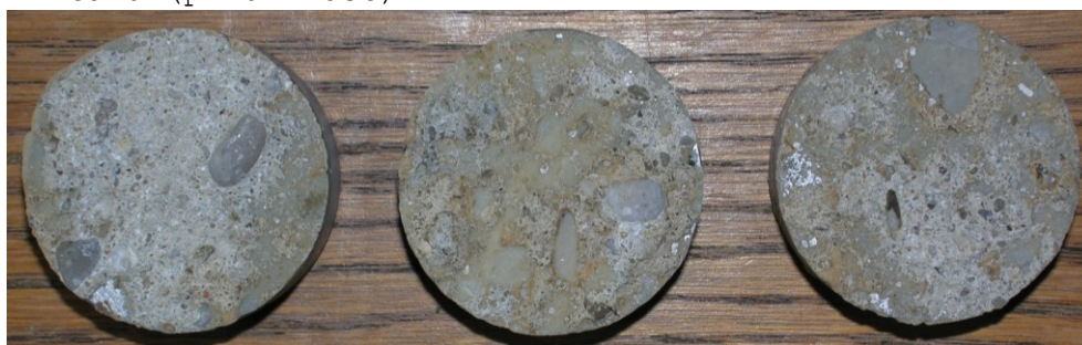
Obr.G42-111 Zkušební terče číslo 43, 171, 177 (zkušební místo 1) po provedení odtrhu.
