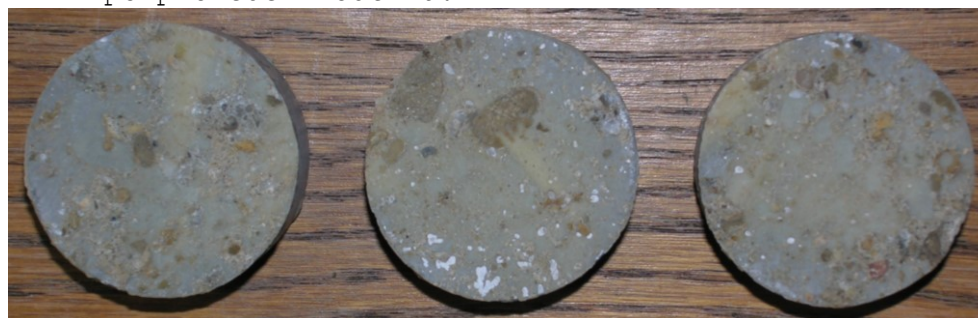
Obr.G42-112 Zkušební terče číslo 71, 100, 198 (zkušební místo 2) po provedení odtrhu.
