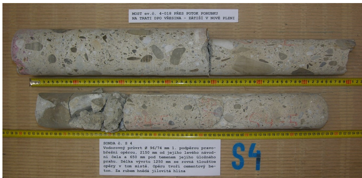
Obr. G42-104 SONDA č. S4. Vodorovný průvrt Ø 96/74 mm 1. podpěrou, pravobřežní opěrou, 2150 mm od jejího levého (návodního) čela a 650 mm pod temenem jejího úložného prahu. Délka vývrtu 1250 mm se rovná tloušťce opěry v tom místě. Opěru tvoří cementový beton. Za rubem hnědá jílovitá hlína.
