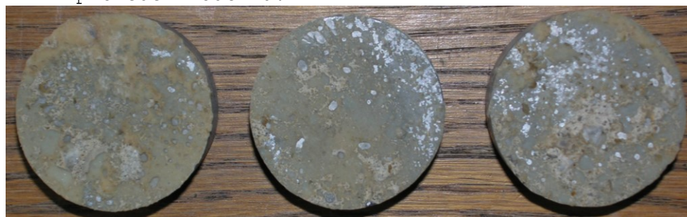
Obr.G42-113 Zkušební terče číslo 18, 107, 188 (zkušební místo 3) po provedení odtrhu.
