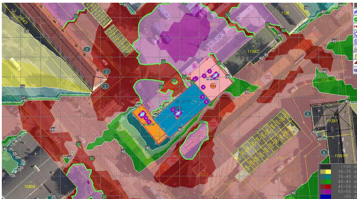
Obr. č. 6 vykreslení izofonových pásem ve výšce 4 m nad terénem
