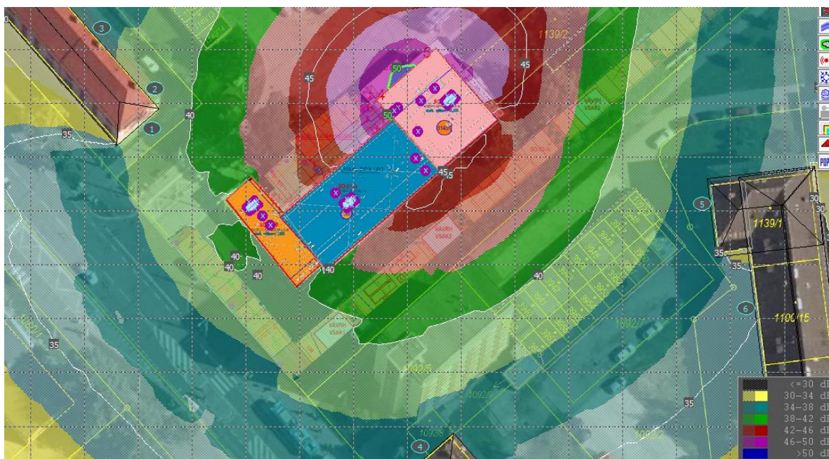
Obrázek č. 12 Vykreslení izofonových pásem – výpočtová hladina 6 m (stav po realizaci protihlukových opatření)
