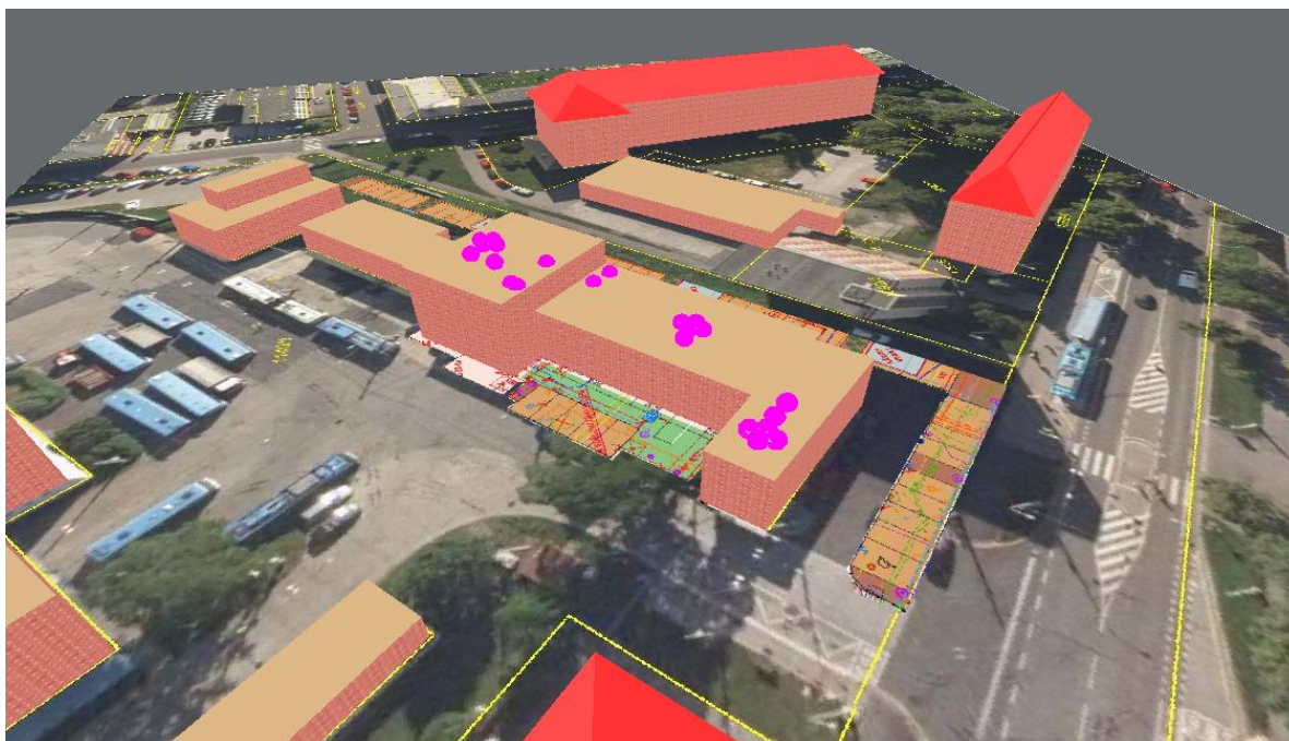
Obr. č. 2 situační snímek akustického výpočetního modelu se zdroji hluku
