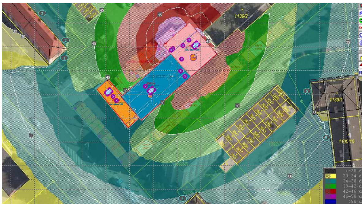
Obrázek č. 11 Vykreslení izofonových pásem – výpočtová hladina 3 m (stav po realizaci protihlukových opatření)
