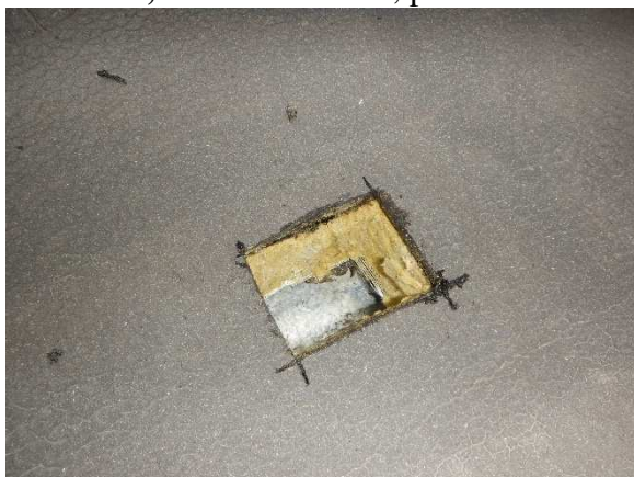
Foto č. 15;16 - sonda ST3-, pohled na sondu ,detail rozvrstvení;
