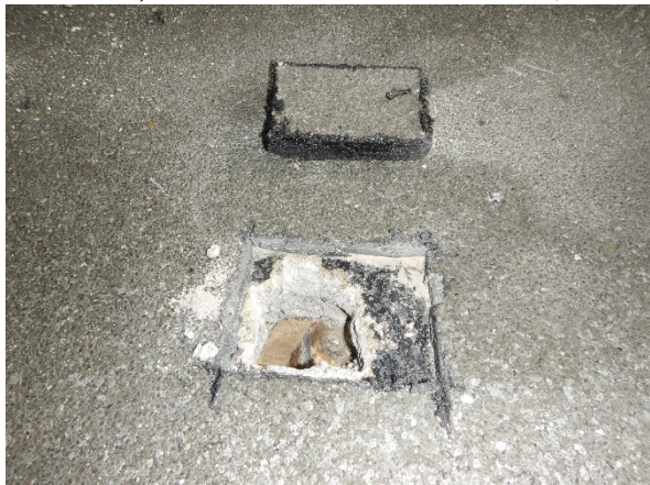
Foto č. 19-22 - sonda ST3- umístění, celkový pohled, přiblížení; detail vrstev zapravení sondy;
