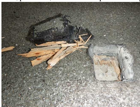
Foto č. 19-22 - sonda ST3- umístění, celkový pohled, přiblížení; detail vrstev zapravení sondy;
