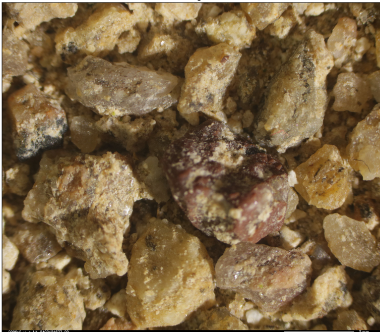
Obr. 8: Mikrofotografie promytého kameniva
