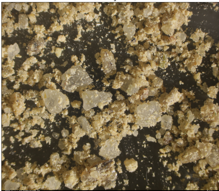
Obr. 4: Mikrofotografie promytého kameniva
