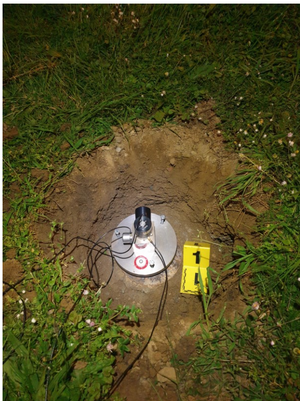
Obr. 4.1 – Příklad instalace měřicí desky na pilotě A1 (foceno 4. 6. 2021)
