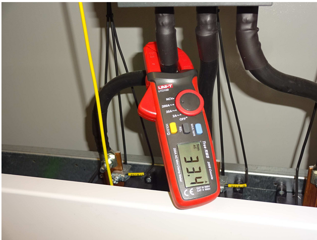
kontrolní měření soudobého proudového zatížení
