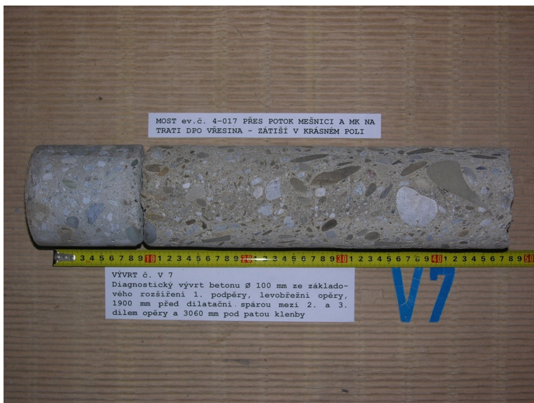
Obr. G43-107 VÝVRT č. V7. Diagnostický vývrt betonu Ø 100 mm ze základového rozšíření 1. podpěry, levobřežní opěry, 1900 mm před dilatační spárou mezi 2. a 3. dílem opěry a 3060 mm pod patou klenby. Bez zkušebního místa NDT (Schmidt).
