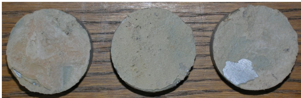
Obr.G43-111 Zkušební terče číslo 68, 78, 126 (zkušební místo 1) po provedení odtrhu.
