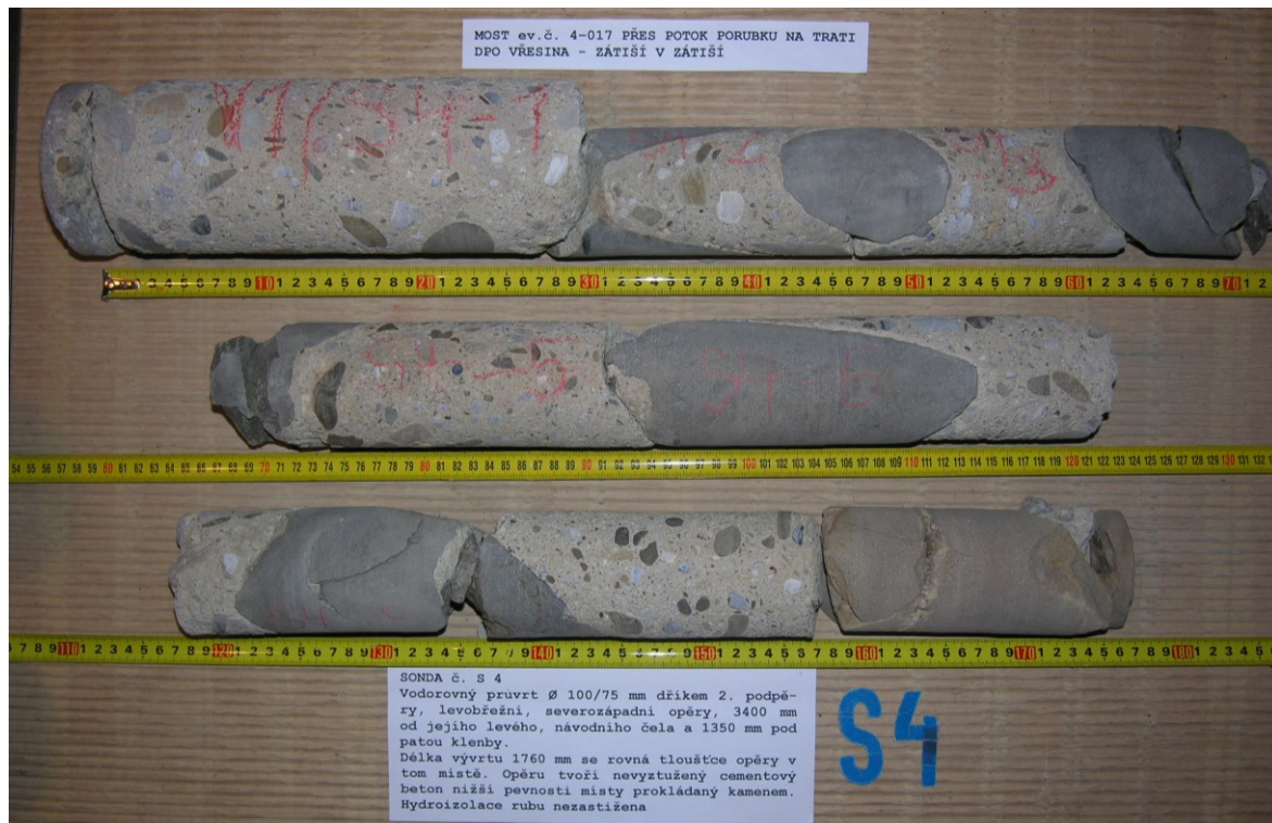
Obr.G45-204 SONDA č. S4. Vodorovný průvrt ø 100/75 mm dříkem 2. podpěry, levobřežní, severozápadní opěry, 3400 mm od jejího levého, návodního čela a 1350 mm pod patou klenby. Délka vývrtu 1760 mm se rovná tloušťce opěry v tom místě. Opěru tvoří nevztužený cementový beton nižší pevnosti prokládaný kamenem. Hydroizolace rubu nezastižena.
