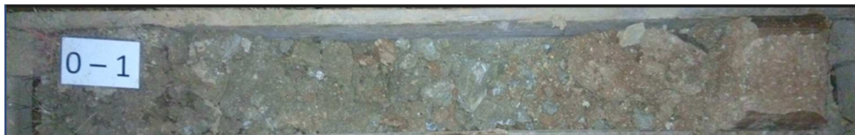
Foto 1 - HV110 (hnědozem: 0,0 – 0,2 m, navážka 0,2 – 0,7 m)
