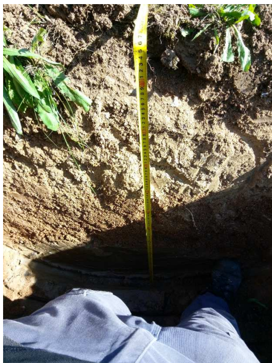
Foto 25 – Profil sondy KS135 (hnědozem 0,0 – 0,1 m)
