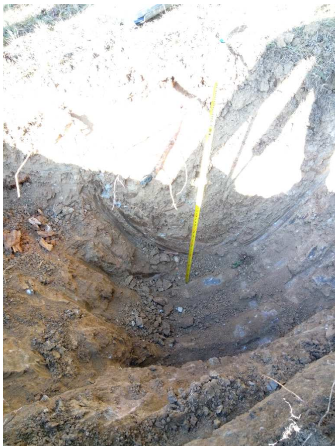
Foto 27 – Profil sondy KS137 (hnědozem 0,0 – 0,1 m, navážka 0,1 – 1,1 m)
