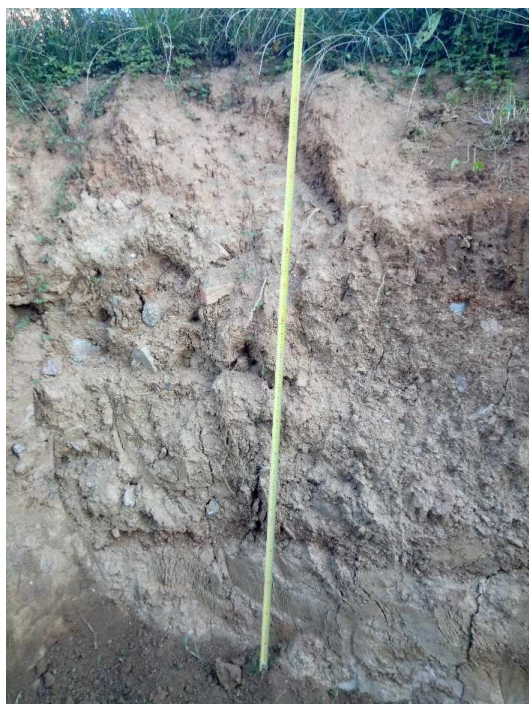
Foto 26 – Profil sondy KS136 (hnědozem 0,0 – 0,1 m, navážka 0,1 – 2,1 m)
