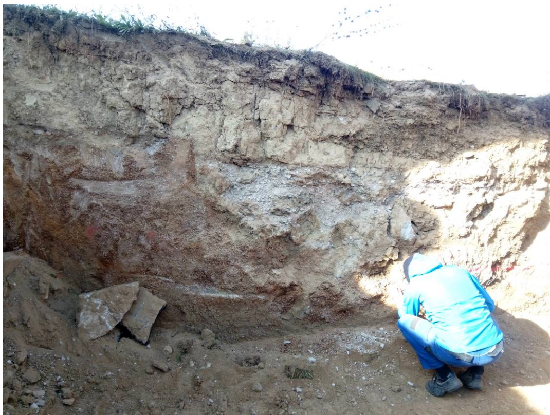
Foto 28 – Profil sondy KS151 (hnědozem 0,0 – 0,15, navážka 0,15 – 0,9 m)
