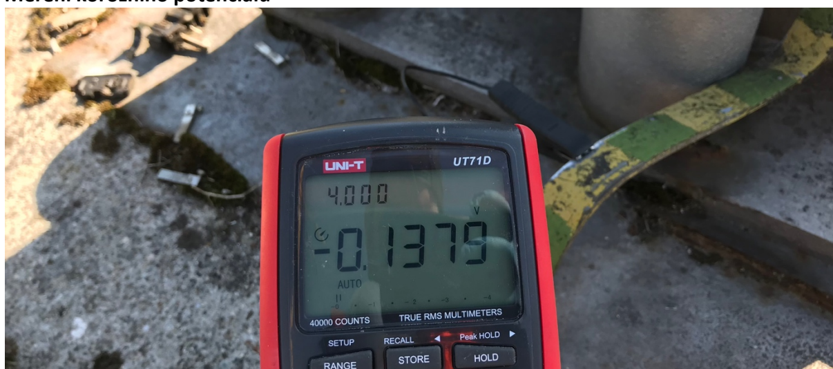
Obr. 5 Jedna z hodnot korozního potenciálu.
