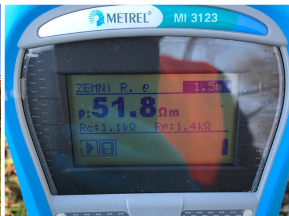
Obr. 2 Měrný odpor půdy do hloubky 1,5 m
