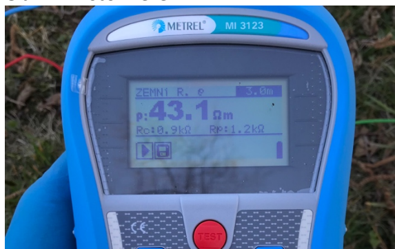
Obr. 3 Měrný odpor půdy do hloubky 3 m
