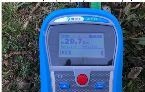
Obr. 4 Měrný odpor půdy do hloubky 5 m
