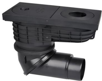
Obr. Lapač střechních splavenin DN110/125 s pohledovými díly z litiny, s kloubem na odtoku, s košem pro zachytávání nečistot, nezámrazná ZU - suchá klapka, s čistícím víkem
