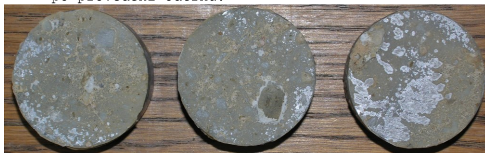
Obr.G45-112 Zkušební terče číslo 34, 49, 52 (zkušební místo 2) po provedení odtrhu.
