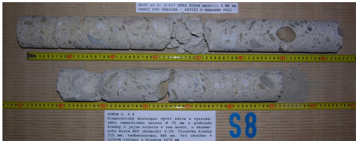
Obr.G43-208 Sonda č. S8. Diagnostický šikmý dostropný vývrt Ø 75 mm ze zdiva z vyztuženého cementového betonu, z podhledu klenby přibližně 1 m za 1. podpěrou, levobřežní opěrou a 1600 mm nad úrovní paty klenby. U zkušebního místa NDT Schmidt č.29. Tloušťka klenby v tomto místě je 715 mm, nadbetonování 1. podpěry 485 mm. Vrt ukončen v jílové izolaci v hloubce 1270 mm.
