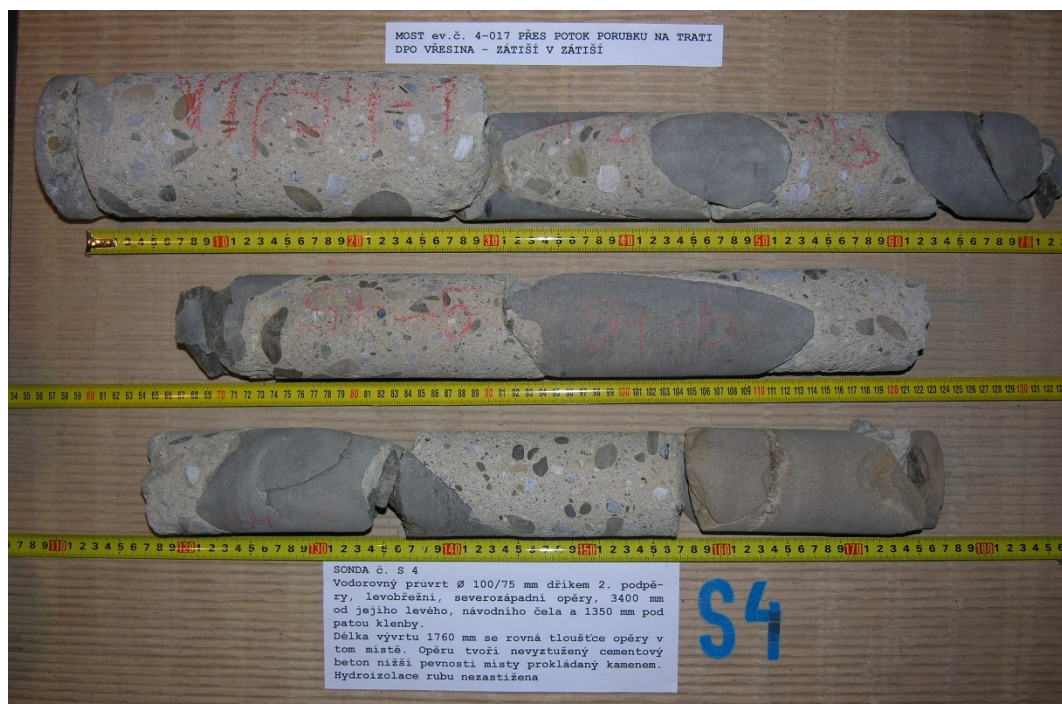
Obr. G45-105 SONDA č. S4. Vodorovný průvrt \varnothing 100/75 mm dříkem 2. podpěry, levobřežní, severozápadní opěry, 3400 mm od jejího levého, návodního čela a 1350 mm pod patou klenby. Délka vývrtu 1760 mm se rovná tloušťce opěry v tom místě. Opěru tvoří nevztužený cementový beton nižší pevnosti prokládaný kamenem. Hydroizolace rubu nezastižena.
