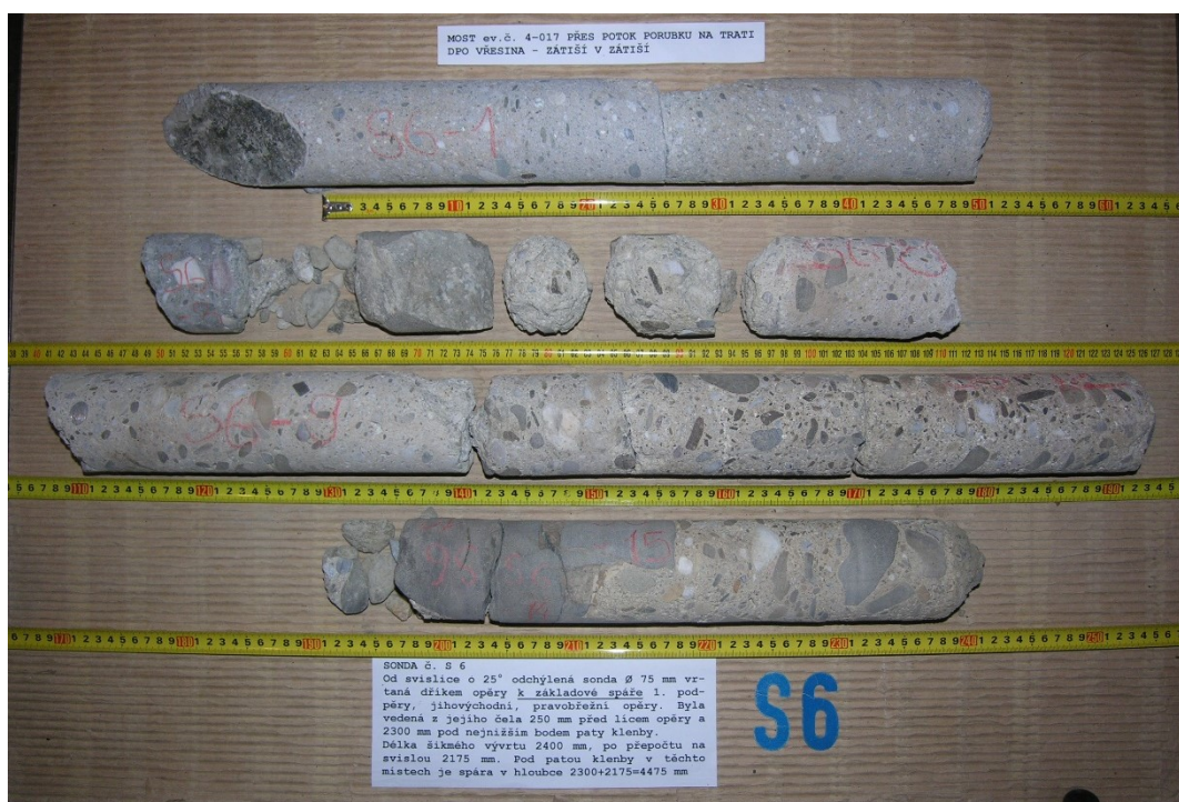
Obr. G45-106 SONDA č. S6. Od svislice odchýlená ( 25^\circ ) sonda \varnothing 75 mm vrtaná dříkem opěry k základové spáře 1. podpěry, jihovýchodní, pravobřežní opěry. Byla vedena z jejího čela 250 mm před lícem opěry a 2300 mm pod nejnižším bodem paty klenby. Délka šikmého vývrtu 2400 mm, po přepočtu na svislou 2175 mm. Pod patou klenby v těchto místech je spára v hloubce 2300 + 2175 = 4475 mm.
