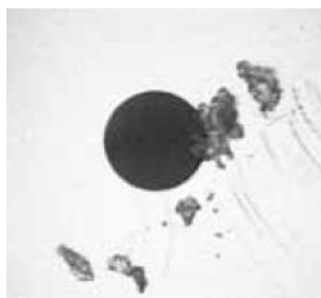
Obrázek 28 snímek znečištěného čela konektoru
