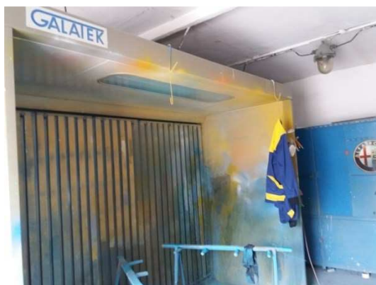
Obrázek č. 22 Odsávací stěna.
