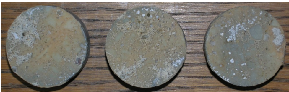
Obr.G41-114 Zkušební terče číslo 19, 67, 168 (zkušební místo 4) po provedení odtrhu.
