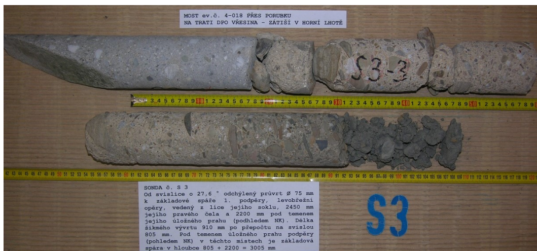
Obr. G44-203 SONDA č. S3. Od svislice odchýlený ( 27,6^\circ ) průvrt Ø 75 mm k základové spáře 1. podpěry, levobřežní opěry, vedený z líce jejího soklu, 2450 mm od jejího pravého čela a 2200 mm pod temenem jejího úložného prahu (podhledem NK). Délka šikmého vývrtu 910 mm po přepočtu na svislou 805 mm. Pod temenem úložného prahu podpěry (pohledem NK) v těchto místech je základová spára v hloubce 805+2200=3005 mm.
