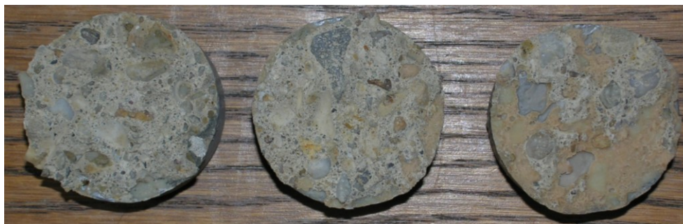
Obr.G41-111 Zkušební terče číslo 5, 21, 138 (zkušební místo 1) po provedení odtrhu.
