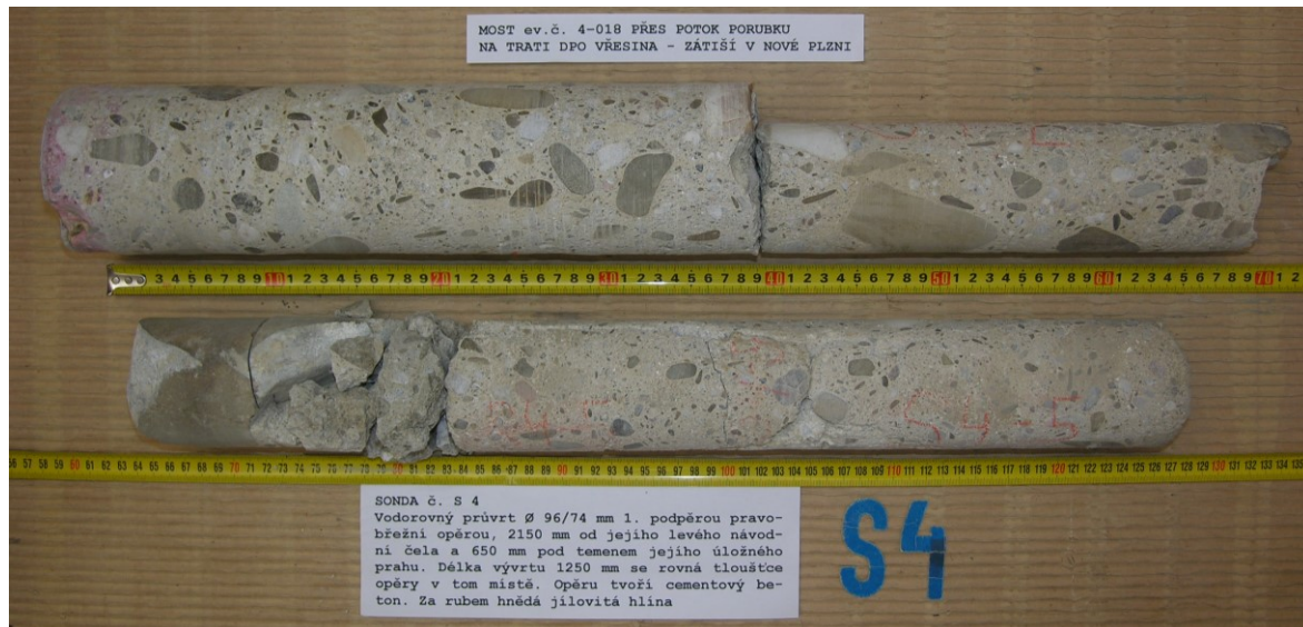
Obr.G42-204 Sonda č. S4. Vodorovný průvrt Ø 96/74 mm 1. podpěrou, pravobřežní opěrou, 2150 mm od jejího levého (návodního) čela a 650 mm pod temenem jejího úložného prahu. Délka vývrtu 1250 mm se rovná tloušťce opěry v tom místě. Opěru tvoří cementový beton. Za rubem hnědá jílovitá hlína.
