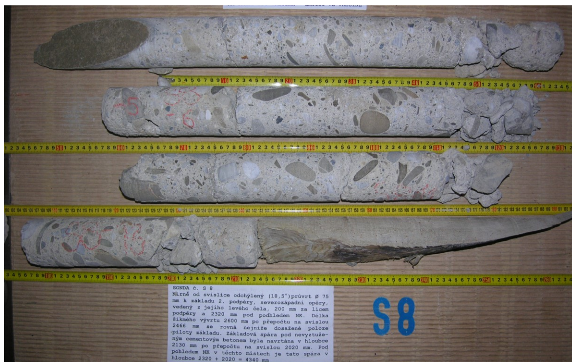
Obr.G41-208 Sonda č. S8. Mírně od svislice odchýlený ( 18,5^\circ ) průvrt \varnothing 75 mm k základu 2. podpěry, severozápadní opěry, vedený z jejího levého čela, 200 mm za lícem podpěry a 2320 mm pod podhledem NK. Délka šikmého vývrtu 2600 mm po přepočtu na svislou 2466 mm se rovná nejníže dosažené poloze piloty základu. Základová spára pod nevyztuženým cementovým betonem byla navrtána v hloubce 2130 mm po přepočtu na svislou 2020 mm. Pod podhledem NK v těchto místech je tato spára v hloubce 2320+2020=4340 mm.
