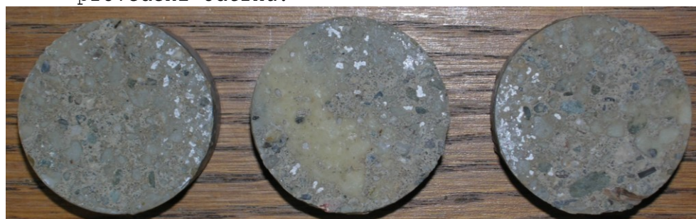
Obr.G45-113 Zkušební terče číslo 95, 113, 180 (zkušební místo 3) po provedení odtrhu.
