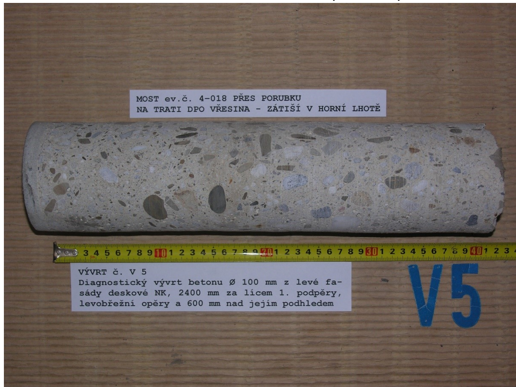
Obr. G44-105 VÝVRT č. V5. Diagnostický vývrt betonu Ø 100 mm z levé fasády deskové NK, 2400 mm za lícem 1. podpěry, levobřežní opěry a 600 mm nad jejím podhledem. U zkušebního místa NDT (Schmidt) č.26.
