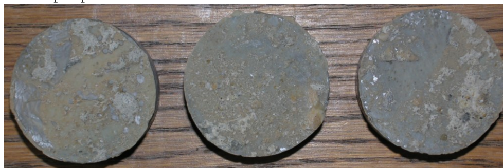
Obr.G41-112 Zkušební terče číslo 69, 116, 189 (zkušební místo 2) po provedení odtrhu.
