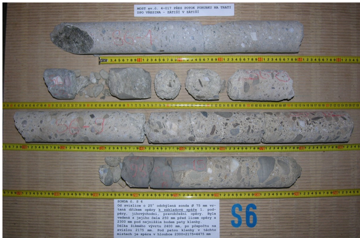
Obr.G45-206 SONDA č. S6. Od svislice odchýlená (25°) sonda ø 75 mm vrtaná dříkem opěry k základové spáře 1. podpěry, jihovýchodní, pravobřežní opěry. Byla vedena z jejího čela 250 mm před lícem opěry a 2300 mm pod nejnižším bodem paty klenby. Délka šikmého vývrtu 2400 mm, po přepočtu na svislou 2175 mm. Pod patou klenby v těchto místech je spára v hloubce 2300 + 2175 = 4475 mm.
