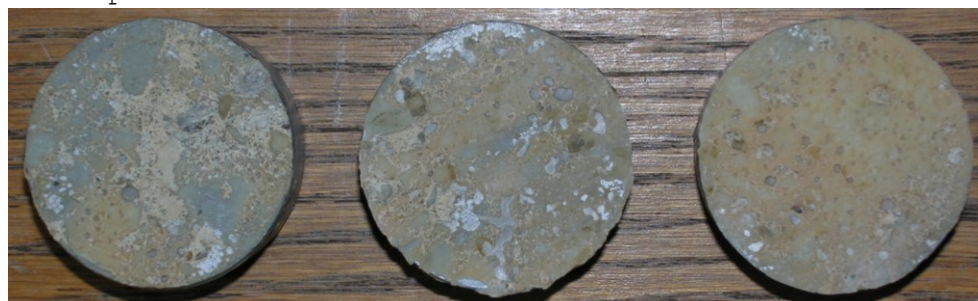
Obr.G41-113 Zkušební terče číslo 80, 115, 185 (zkušební místo 3) po provedení odtrhu.
