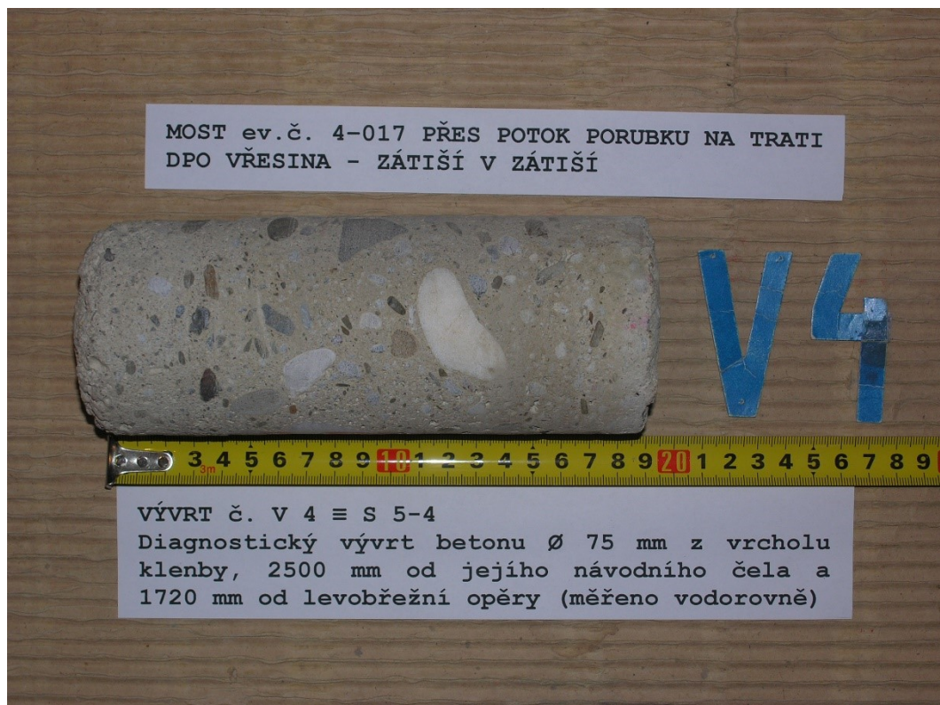
Obr. G45-104 VÝVRT č. V4 ≡ S 5-4. Diagnostický vývrt betonu Ø 75 mm z vrcholu klenby, 2500 mm od jejího návodního čela a 1720 mm od levobřežní opěry (měřeno vodorovně). U zkušebního místa NDT (Schmidt) č.30.
