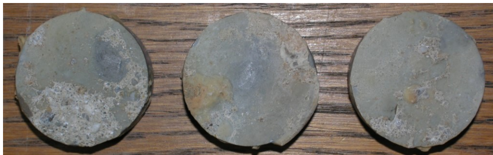
Obr.G45-111 Zkušební terče číslo 16, 65, 74 (zkušební místo 1) po provedení odtrhu.
