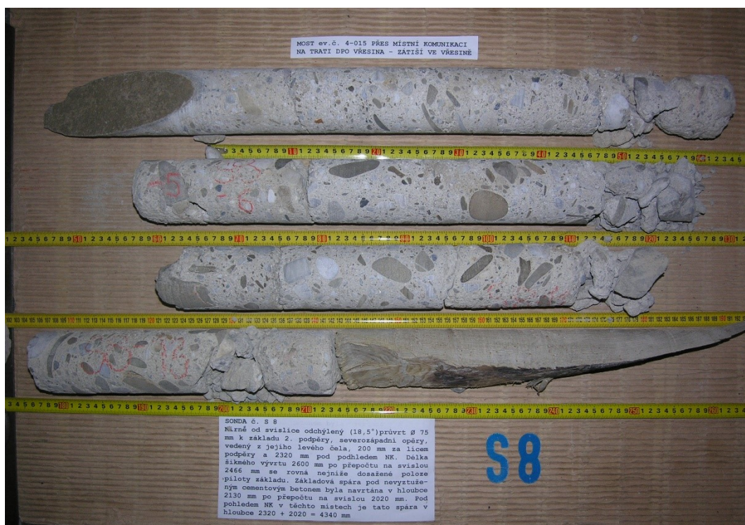
Obr. G41-108 SONDA č. S8. Mírně od svislice odchýlený (18,5°) průvrt \varnothing 75 mm k základu 2. podpěry, severozápadní opěry, vedený z jejího levého čela, 200 mm za lícem podpěry a 2320 mm pod podhledem NK. Délka šikmého vývrtu 2600 mm po přepočtu na svislou 2466 mm se rovná nejnižší dosažené poloze piloty základu. Základová spára pod nevyztuženým cementovým betonem byla navrtána v hloubce 2130 mm po přepočtu na svislou 2020 mm. Pod pohledem NK v těchto místech je tato spára v hloubce 2320 + 2020 = 4340 mm.
