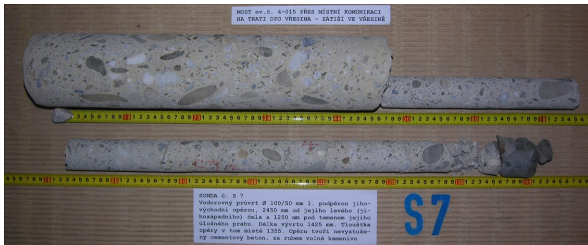
Obr.G41-207 Sonda č. S7. Vodorovný průvrt \varnothing 100/50 mm 1. podpěrou, jihovýchodní opěrou, 2450 mm od jejího levého (jihozápadního) čela a 1250 mm pod temenem jejího úložného prahu. Délka vývrtu 1425 mm. Tloušťka opěry v tom místě 1355 mm. Opěru tvoří nevzdušný cementový beton. Za rubem volné kamenivo.
