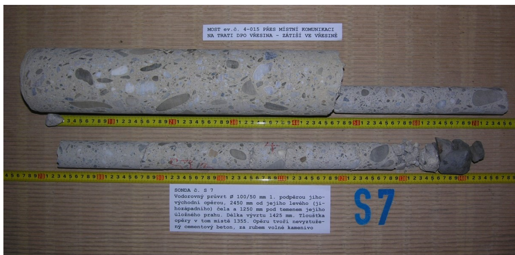
Obr. G41-107 SONDA č. S7. Vodorovný průvrt \varnothing 100/50 mm 1. podpěrou, jihovýchodní opěrou, 2450 mm od jejího levého (jihozápadního) čela a 1250 mm pod temenem jejího úložného prahu. Délka vývrtu 1425 mm. Tloušťka opěry v tom místě 1355 mm. Opěru tvoří nevyztužený cementový beton, za rubem volné kamenivo.
