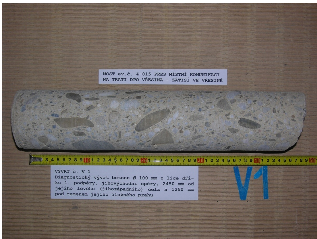
Obr. G41-101 VÝVRT č. V1. Diagnostický vývrt betonu Ø 100 mm z líce dříku 1. podpěry, jihovýchodní opěry, 2450 mm od jejího levého (jihozápadního) čela a 1250 mm pod temenem jejího úložného prahu. U zkušebního místa NDT (Schmidt) č.5.
