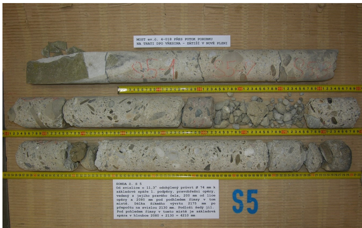
Obr. G42-105 SONDA č. S5. Mírně od svislice odchýlený ( 11,3^\circ ) průvrt \varnothing 74 mm k základové spáře 1. podpěry, pravobřežní opěry, vedený z jejího pravého čela, 200 mm od líce opěry a 2080 mm pod podhledem římsy v tom místě. Délka šikmého vývrtu 2175 mm po přepočtu na svislou 2130 mm. Podloží šedý jíl. Pod pohledem římsy v tomto místě je základová spára v hloubce 2080 + 2130 = 4210 mm.
