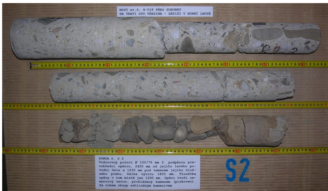
Obr. G44-202 SONDA č. S2. Sonda č. S2. Vodorovný průvrt Ø 100/75 mm 2. podpěrou, pravobřežní opěrou, 2450 mm od jejího levého (povodního) čela a 1230 mm pod temenem jejího úložného prahu. Délka vývrtu 1800 mm. Tloušťka opěry v tom místě je 1290 mm. Opěru tvoří cementový beton prokládaný kamenem (pískovcem). Za rubem obsyp zahliněným kamenivem.
