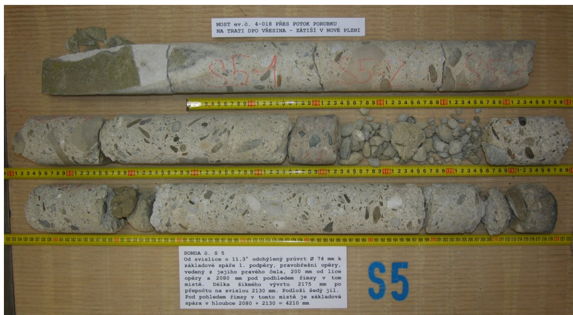
Obr.G42-205 Sonda č. S5. Mírně od svislice odchýlený ( 11,3^\circ ) průvrt \varnothing 74 mm k základové spáře 1. podpěry, pravobřežní opěry, vedený z jejího pravého čela, 200 mm od líce opěry a 2080 mm pod podhledem římsy v tom místě. Délka šikmého vývrtu 2175 mm po přepočtu na svislou 2130 mm. Podloží šedý jíl. Pod podhledem římsy v tom místě je základová spára v hloubce 2080+2130=4210 mm.
