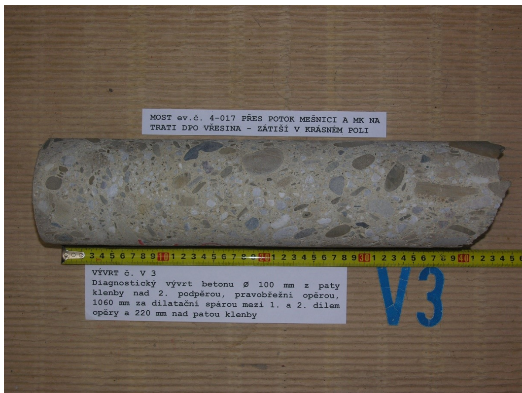
Obr. G43-103 VÝVRT č. V3. Diagnostický vývrt betonu Ø 100 mm z paty klenby nad 2. podpěrou, pravobřežní opěrou, 1060 mm za dilatační spárou mezi 1. a 2. dílem opěry a 220 mm nad patou klenby. Bez zkušebního místa NDT (Schmidt).
