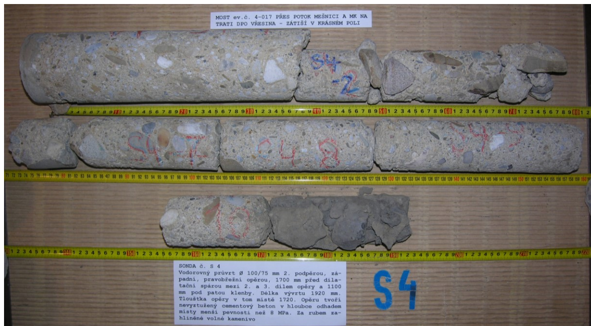
Obr.G43-204 Sonda č. S4. Vodorovný průvrt \varnothing 100/75 mm 2. podpěrou, západní, pravobřežní opěrou, 1700 mm před dilatační spárou mezi 2. a 3. klenebním pásem a 1100 mm pod patou klenby. Délka vývrtu 1920 mm. Tloušťka opěry v tom místě 1720 mm. Opěru tvoří cementový beton, v hloubce odhadem místy menší pevnosti než 8 Mpa. Za rubem zahliněné volné kamenivo.
