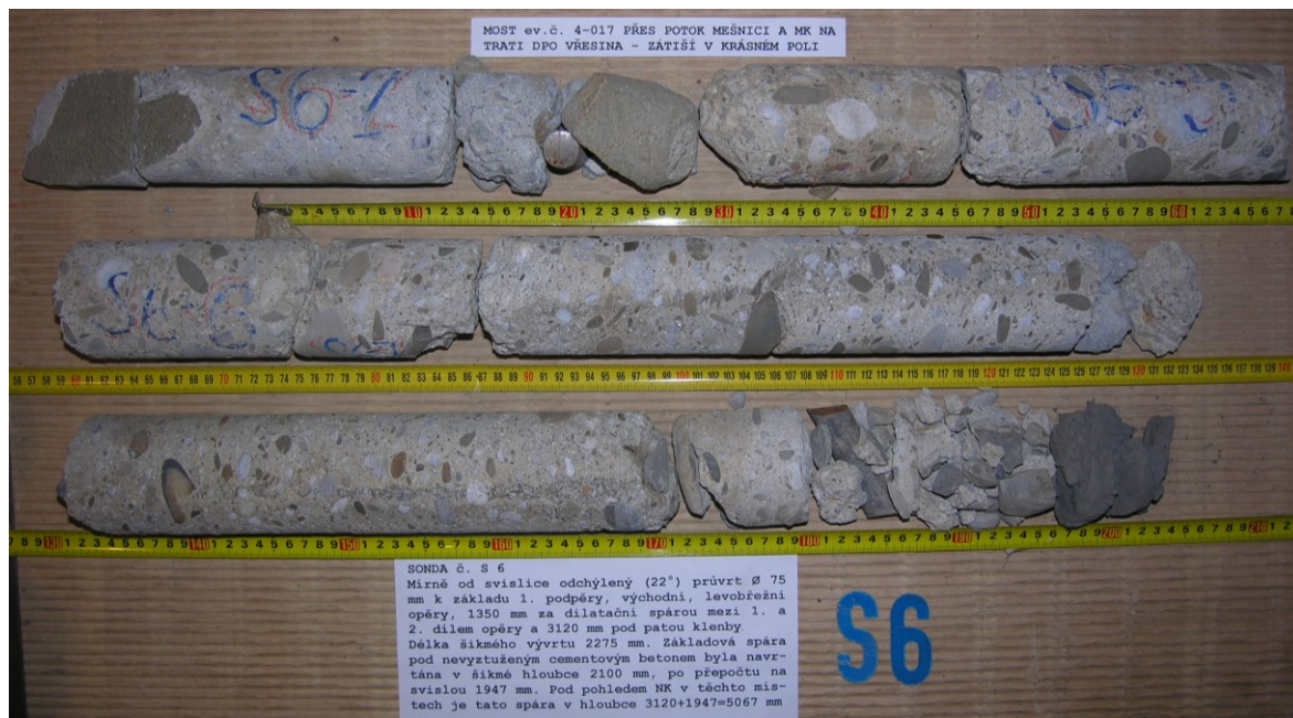
Obr.G43-206 Sonda č. S6. Mírně od svislice odchýlený ( 22^\circ ) průvrt \varnothing 75 mm k základu 1. podpěry, východní, levobřežní opěry, 1350 mm za dilatační spárou mezi 1. a 2. klenbovým pásem a 3120 mm pod patou klenby. Délka šikmého vývrtu 2275 mm. Základová spára pod vyztuženým cementovým betonem byla navrtána v šikmé hloubce 2100 mm, po přepočtu na svislou 1947 mm. Pod pohledem NK v těchto místech je tato spára v hloubce 3120+1947=5067 mm.
