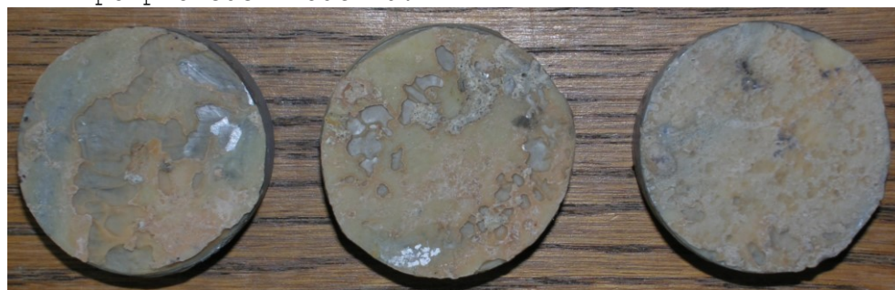
Obr.G43-112 Zkušební terče číslo 108, 161, 194 (zkušební místo 2) po provedení odtrhu.
