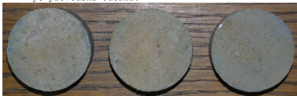
Obr.G43-113 Zkušební terče číslo 7, 182, 193 (zkušební místo 3) po provedení odtrhu.
