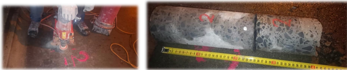
Obr.: Vlevo provádění sondy DP-02-B, vpravo odvrtný vzorek.
