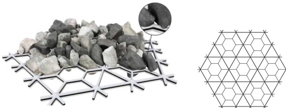
Obr.: Předpokládaná podoba požadované stabilizační geomříže. Vlevo obrázek principu zaklínění kamenů, vpravo půdorys vhodného tvaru stabilizační geomříže.
