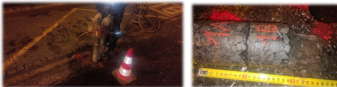
Obr.: Vlevo provádění sondy DP-01-A, vpravo odvrtný vzorek.
