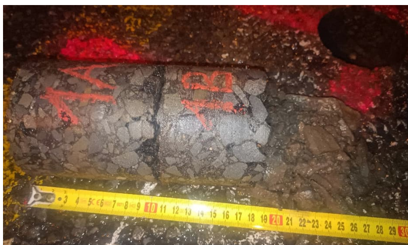
Obrázek 3 Sonda DP-01-A, skladba – foto (vzorky 1A, 1B)
