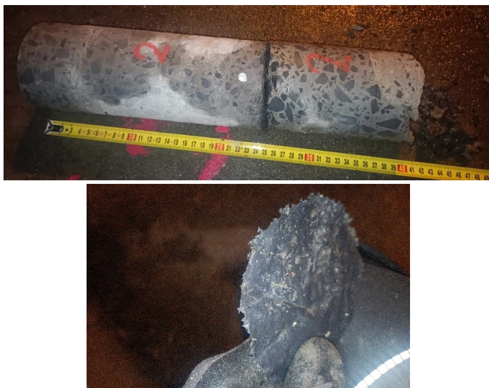
Obrázek 5 Sonda DP-02-B, skladba – foto (nahore), izolační fólie (dolů)
