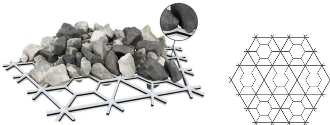
Obr.: Předpokládaná podoba požadované stabilizační geomříže. Vlevo obrázek principu zaklínění kamenů, vpravo půdorys vhodného tvaru stabilizační geomříže.
