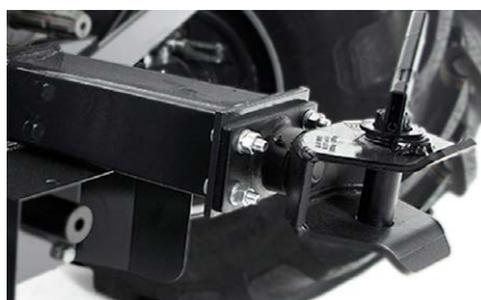
Zadní tažný hák schválený pro přívěsy do 6 000 kg (volitelný hydraulický nebo pneumatický brzdový systém pro tažení až 14 000 kg).
