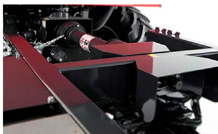
Centrální vývodový hřídel s nezávislou dvoustupňovou hydraulickou spojkou (540/1000 ot./min.), s elektrohydraulickým ovládáním.
