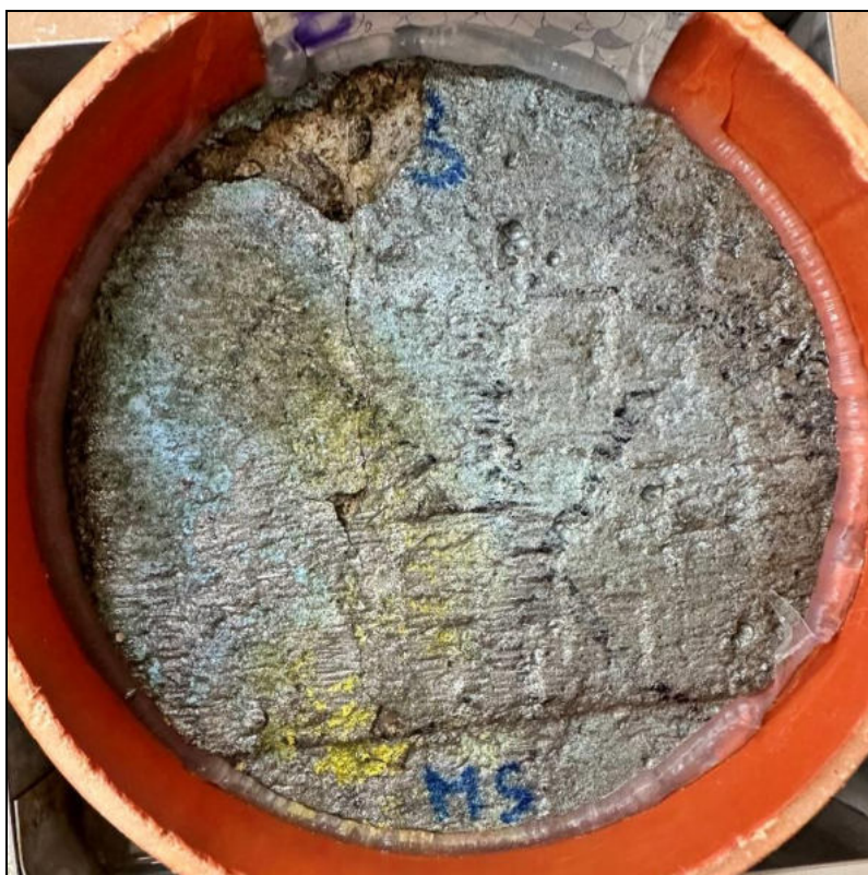
Foto 12: Líc vzorku CHRL3 po zkoušce – 75 cyklů Celkový odpad 248 g/m 2
