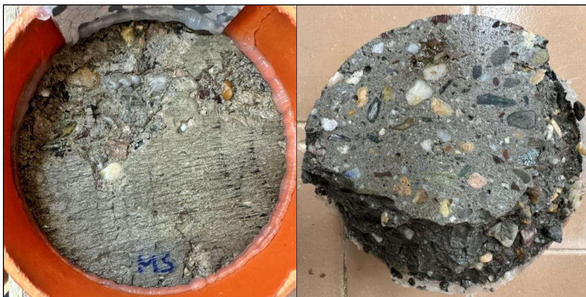
Foto 14: Líc (vlevo) a rub (vpravo) vzorku CHRL4 po zkoušce – 75 cyklů Celkový odpad 2651 g/m 2 Porušení na cca 1/2 čelní plochy, částečný rozpad rubové plochy zkušebního tělesa
