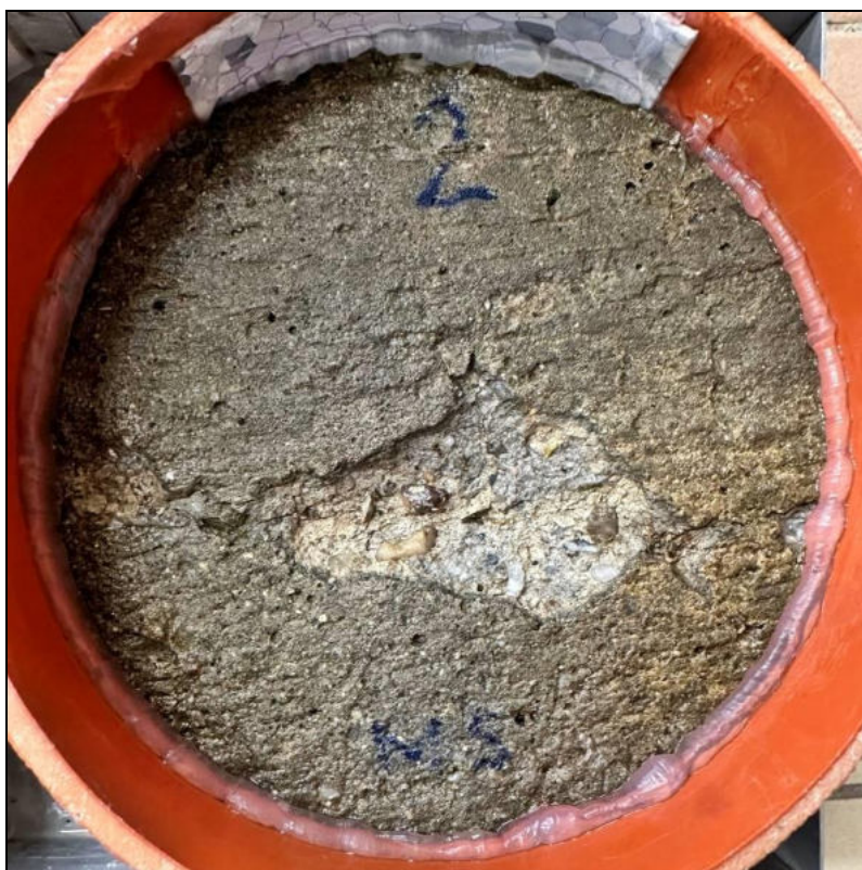
Foto 10: Líc vzorku CHRL2 po zkoušce – 75 cyklů Celkový odpad 1262 g/m 2 Porušení v ojedinělých místech čelní plochy
