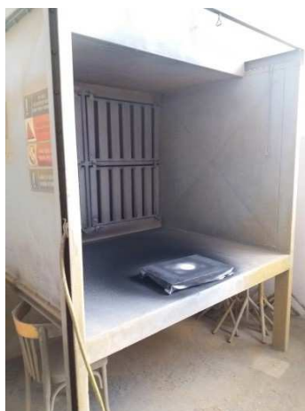
Obrázek č. 32 Odsávací stěna pro nanášení barev stříkáním.
