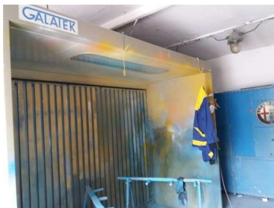
Obrázek č. 22 Odsávací stěna.
