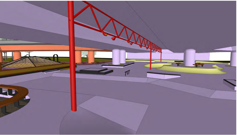
NEVHODNÁ VARIANTA příhradová konstrukce, která drží jednotlivá svítidla kotvená na stožárový sloup
