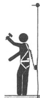
Zajišťovací systém proti pádu s vedeným zachycovačem pádu
